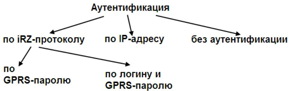
Рис. 4.8 Типы аутентификации клиентов при подключении к модему-серверу
