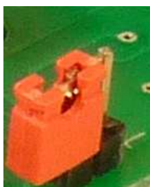
Рис. 5. Переключатель подключения терминирующего резистора.
