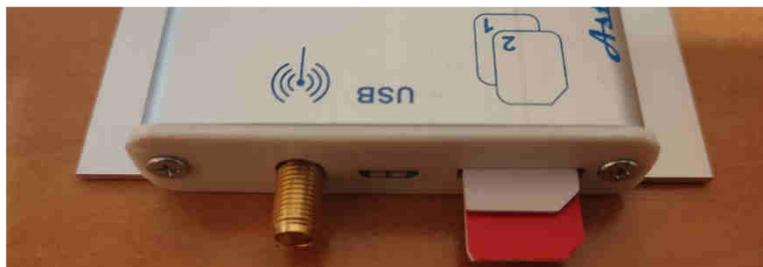
При использовании модема только с одной СИМ-картой, необходимо её устанавливать в слот держателя для SIM1. Если же карта будет ошибочно установлена в слот держателя для SIM2, то модем полностью сохраняет свою работоспособность, правда, в этом случае будет немного повышенный GPRS-трафик из-за попыток модема переключаться на карту SIM1 каждые 3 часа.
