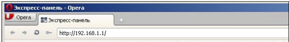
Рис. 3.1 Ввод IP-адреса роутера в адресную строку интернет-браузера
