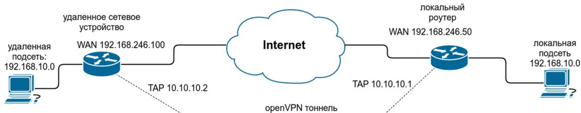
Рис. 3 Примеры конфигураций OpenVPN. Схема сети
