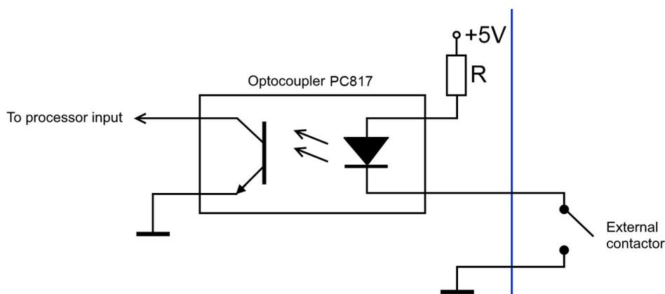
Рис. 3. Дискретный вход контроллера Socket-1.
