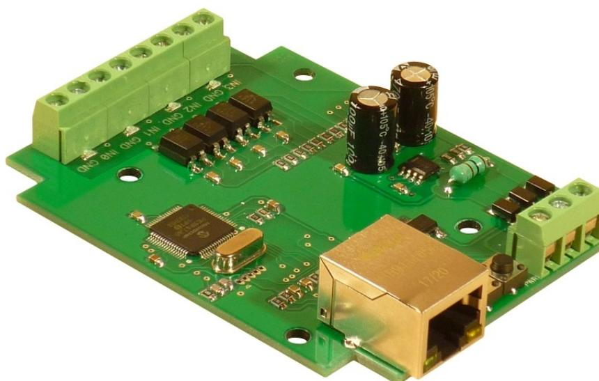
Рис.2. Плата контроллера Socket-1.
