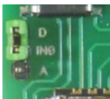
Рис. 1. Переключатель режимов работы входа 0.
